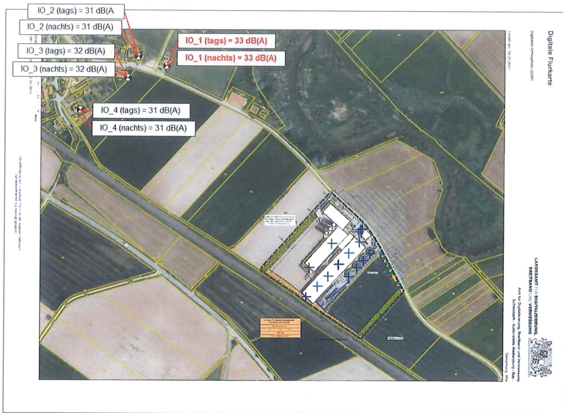
Abbildung 5: Ergebnisse der Lärmimmissionsprognose-Regelbetrieb Biogasanlage und Betrieb der Schweinehaltung
